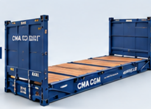
Flat Rack Container For ODC & heavy cargo
